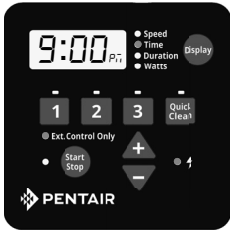
Abbildung 7: Ausschließlich externe Steuerung aktivieren
