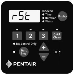
Figura 14: ripristino delle impostazioni di fabbrica del convertitore
