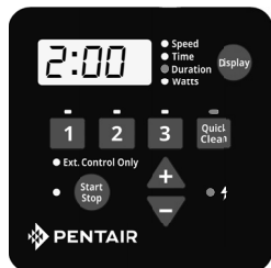
Abbildung 13: Festlegen der Dauer für die Schnellreinigung
