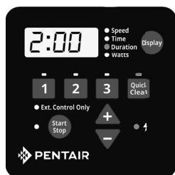
Figure 13 : Réglage de la durée de Quick Clean
