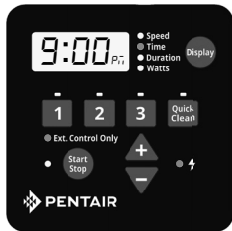
Figura 7: attivazione della modalità di controllo esclusivamente esterno
