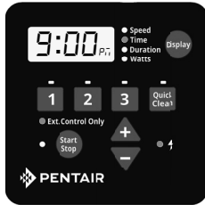
Figura 7: Activación del modo de control externo exclusivo
