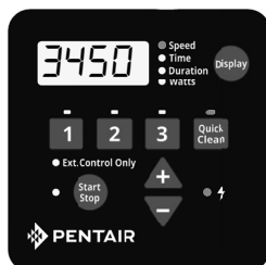
Figure 12 : Réglage de la vitesse de Quick Clean
