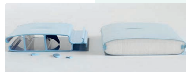
Na de hageltest, uitgevoerd door een extern en onafhankelijk laboratorium. Links: Standaard holle lamellen Rechts: Covrex® Classic lamellen
